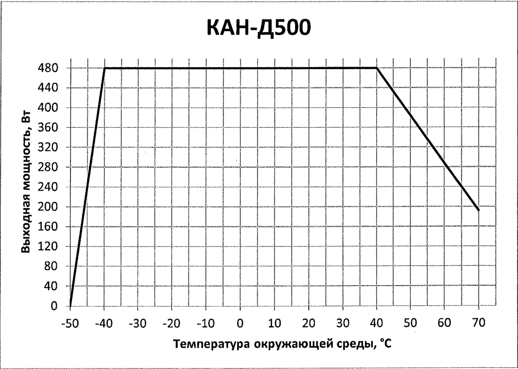
Рисунок Г.7 — График зависимости выходной мощности модуля от температуры окружающей среды для модулей КАН-Д500
